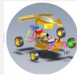
Vue éclatée de la voiture à l'aide du logiciel Solidworks
